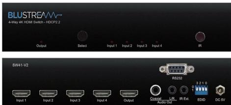
我们的 HDMI 切换器内置音频解嵌，可以通过红外，前控制面板和 RS-232 去控制。该切换器支持包括 4K 在内的所有视频分辨率。
