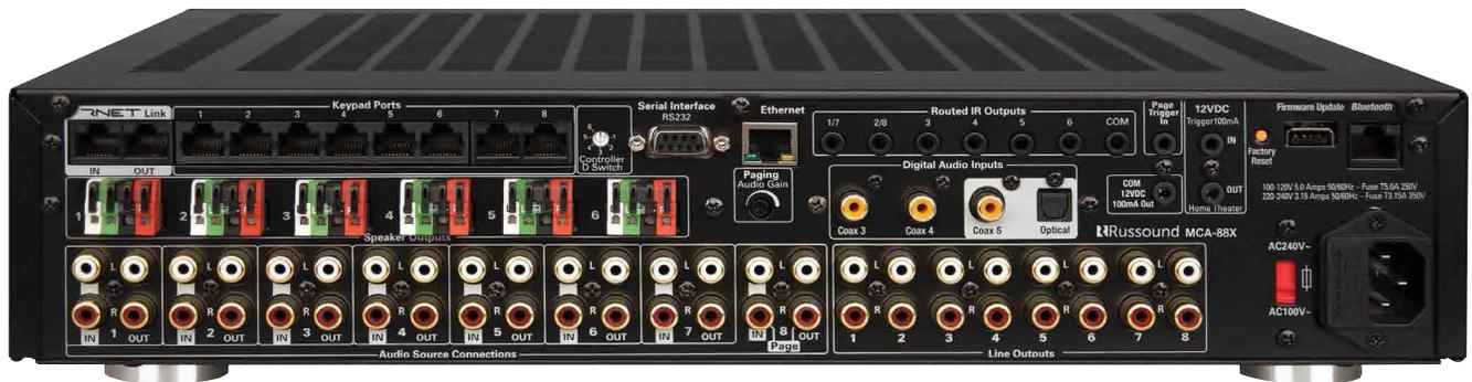
全新的MCA系列控制器内置有XStream，允许从每个区域访问客户的音乐和获得流媒体服务。基于Russound有口皆碑的可靠性、简易性和音质，新一代多分区控制器可实现更快的响应时间、多种数字输入、更快的配置和更丰富的内容选择。此产品系列的旗舰机型是MCA-88X，它不仅提供MCA-88的所有功能，还引入了专用XStream流媒体音源，允许播放来自互联网或您自己的数字音乐库的最佳音乐。XStream音源可以由家里的各个区域共享，也可以添加多台XSource从而支持额外XStream音源。直观的MyRussound™应用程序让用户可以方便地控制整个系统，并使用平板电脑和手机显示元数据\*。此外，更提供多种按键面板、触摸屏和手持遥控器选项，确保于任何位置都可实现最佳的控制方式。
